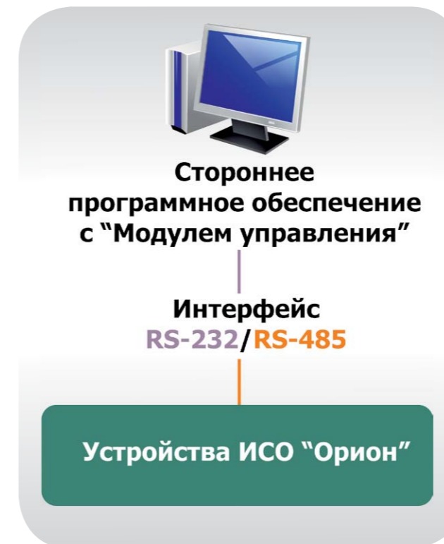
Рисунок 55. Интеграция с устройствами посредством «Модуля управления»
