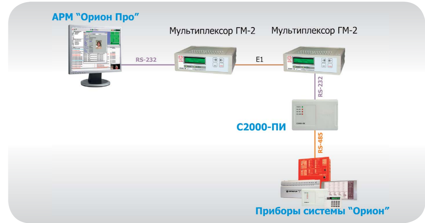
Рисунок 66. Структурная схема использования мультиплексора «ГМ-2» с АРМ «Орион»/«Орион Про»
