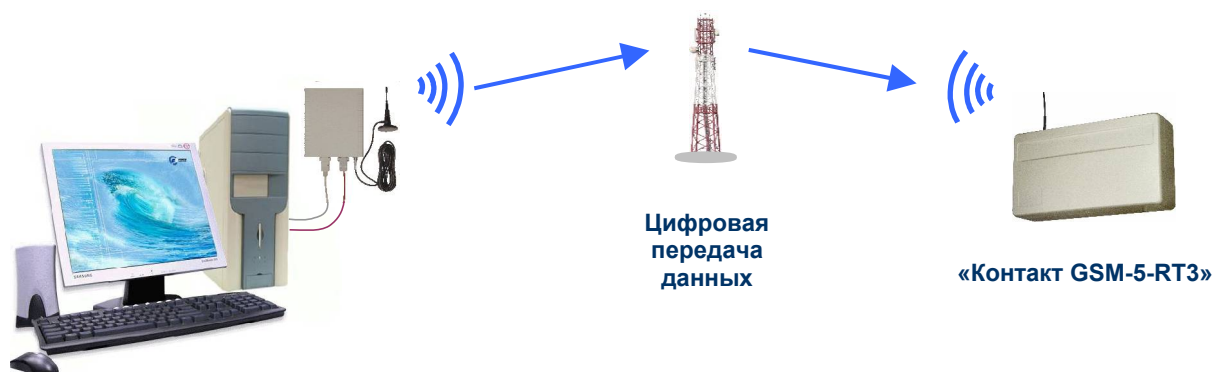
Рис.5.4. Подключение «Контакта GSM-5-RT3» к компьютеру через цифровое соединение сотовой сети.
