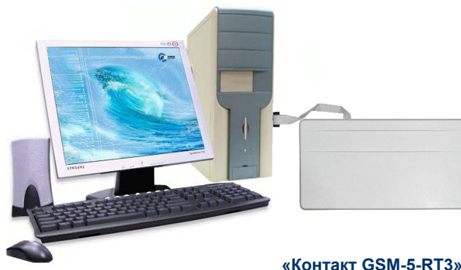
Рис.5.2. Подключение «Контакта GSM-5-RT3» к компьютеру через кабель программирования (кабель для связи с компьютером USB 1 или USB 2)
