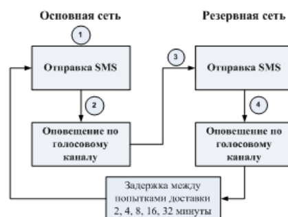
Рис. 2. Алгоритм оповещения в режиме автономной охраны
