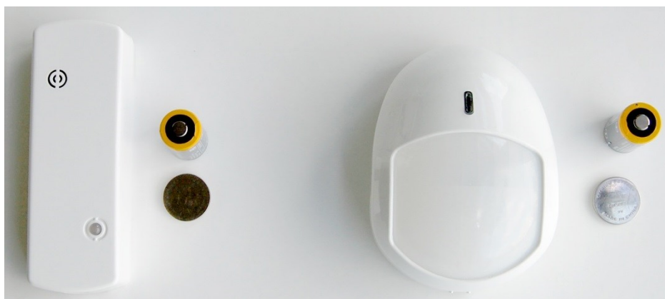
Рис. 18. Радиоизвещатели Ладога-МК-РК и Фотон-19-РК и их элементы питания (вверху — основные, внизу — резервные)
