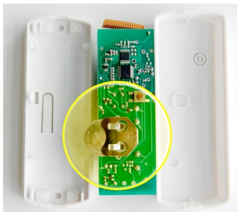
Рис. 20. Установка резервного элемента питания в радиоизвещатель Ладога-МК-РК
