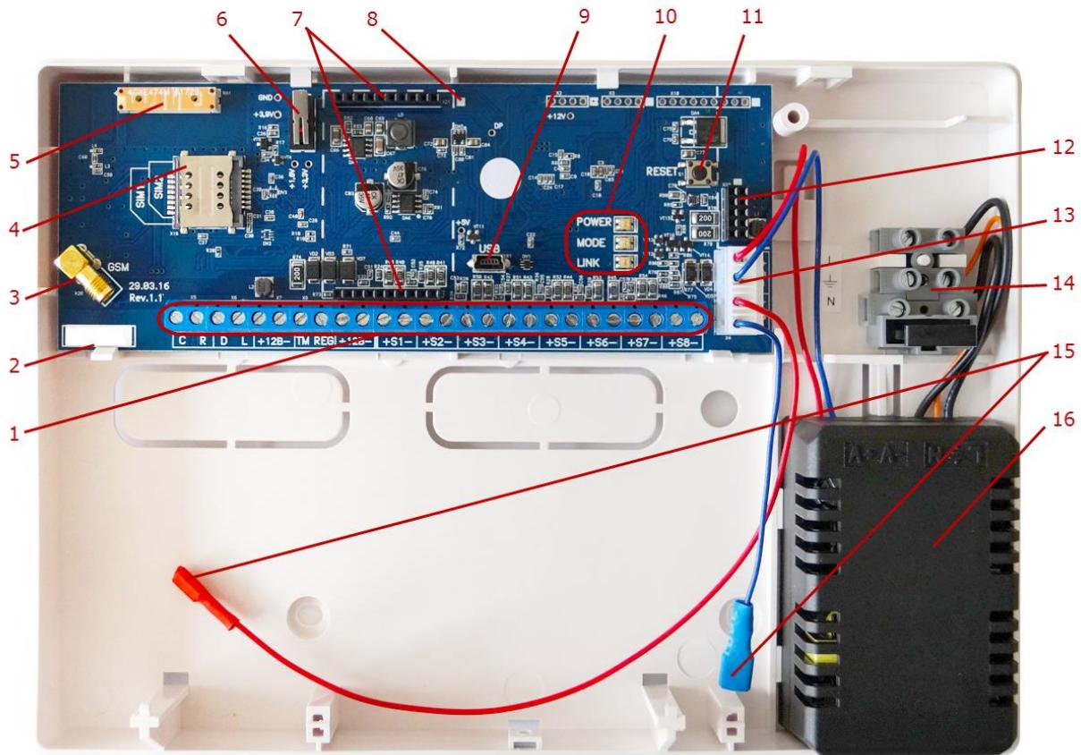
Вид контроллера со снятой крышкой
