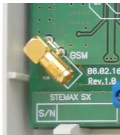
Рис. 4.3. SMA-разъем для подключения GSM-антенны
