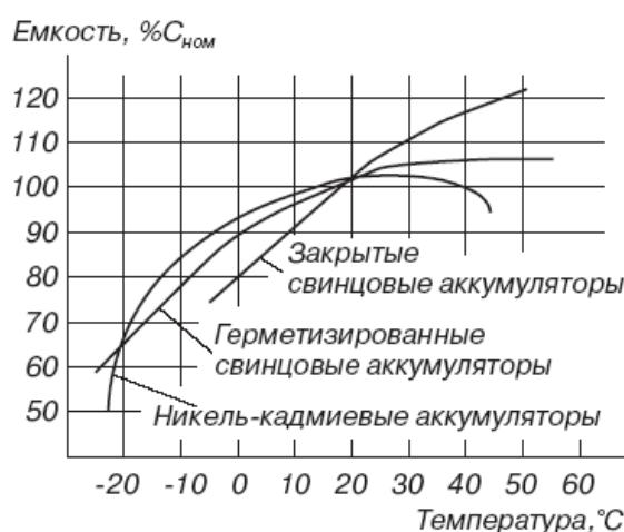
Рис. 3.4. Зависимость емкости АКБ от температуры
