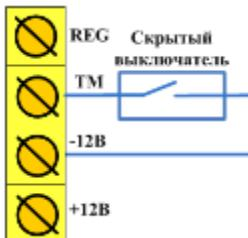
Рис. 4.4. Схема подключения скрытого выключателя
