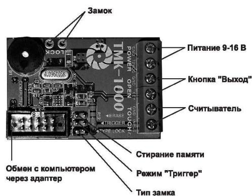
**Замок** - Выход для подключения исполнительного устройства (замок, сигнализация и т д.)
