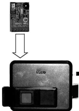
При использовании с электромеханическим замком, плата устанавливается рядом.
